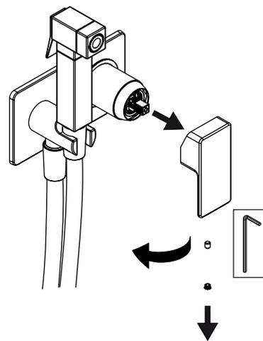
SOSTITUZIONE DELLA LEVA DI COMANDO
