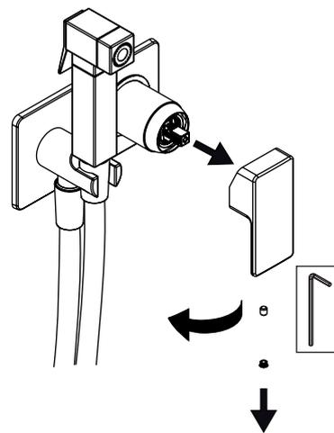
SOSTITUZIONE DELLA LEVA DI COMANDO
