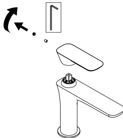
SOSTITUZIONE DELLA LEVA DI COMANDO
