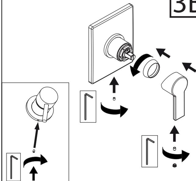
SOSTITUZIONE DELLA LEVA DI COMANDO
