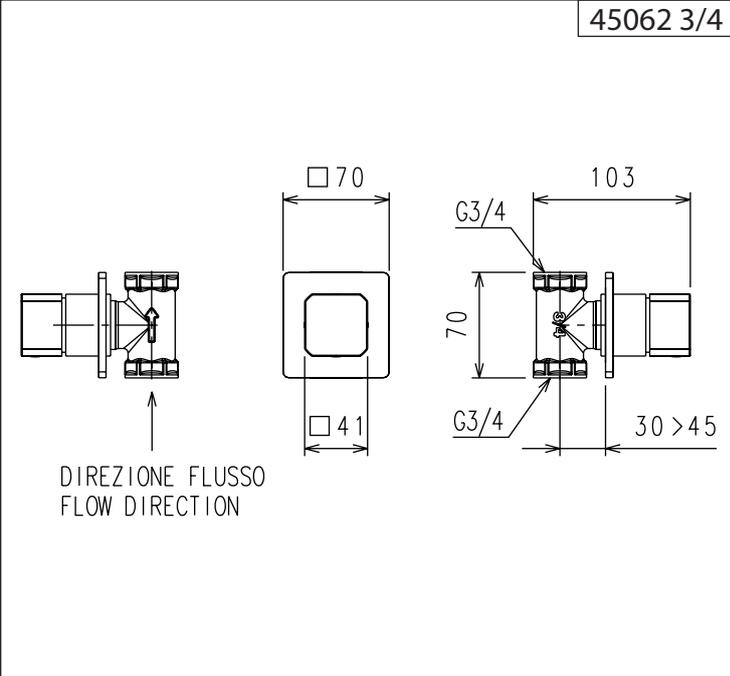
> ATTENZIONE A SIGILLARE LE ENTRATE/USCITA ACQUA CON TEFLON O MATERIALE IDRAULICO SPECIFICO
