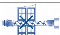
Avvitare i raccordi con tenuta oring a mano coppia massima di serraggio 3 Nm.
