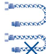
Prima dell'inizio della curvatura lasciare un tratto rettilineo di almeno 1.5 - 2 volte il diametro esterno.
