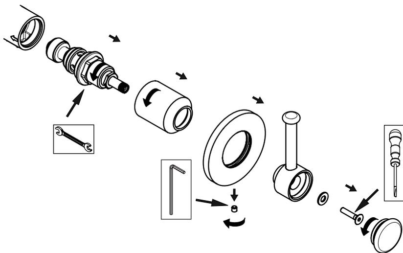
SOSTITUZIONE VITONE PER REGOLAZIONE FLUSSO
