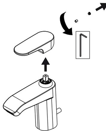
SOSTITUZIONE DELLA LEVA DI COMANDO
