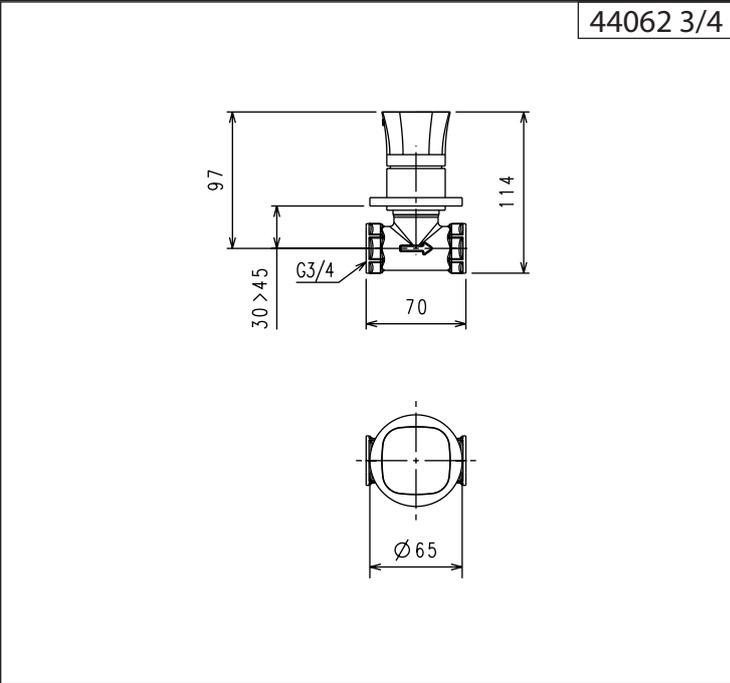
> ATTENZIONE A SIGILLARE LE ENTRATE/USCITA ACQUA CON TEFLON O MATERIALE IDRAULICO SPECIFICO
