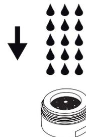
> IN CASO DI SCARSO FLUSSO PROVARE A RIPULIRE L' AERATORE SOTTO GETTO ACQUA CORRENTE O ARIA E RIMONTARE SU CORPO
